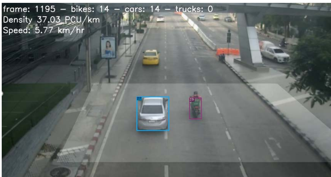
รูปที่ 3.3-19 ตัวอย่างภาพวิดีโอขนาด 2,000,000 pixels 15 frames/second จากกล้อง CCTV ของกรุงเทพมหานคร
