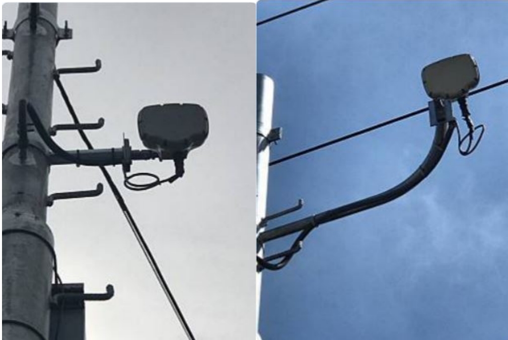
รูปที่ 2.2-3 ตัวอย่างอุปกรณ์ Microwave Radar Sensors ที่ใช้ในการนับปริมาณจราจรของกรมทางหลวง
