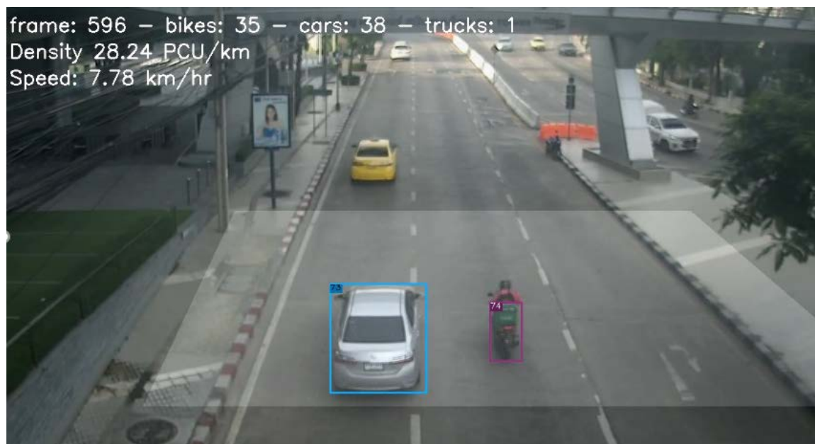
รูปที่ 3.3-20 ตัวอย่างภาพวิดีโอขนาด 2,000,000 pixels 5 frames/second จากกล้อง CCTV ของกรุงเทพมหานคร
