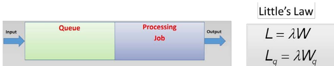
รูปที่ 3.3-30 การวิเคราะห์ความยาวแถวคอยโดยใช้หลักการของ Queuing Theory
