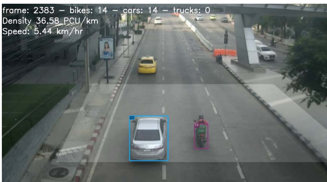
รูปที่ 3.3-18 ตัวอย่างภาพวิดีโอขนาด 2,000,000 pixels 25 frames/second จากกล้อง CCTV ของกรุงเทพมหานคร
