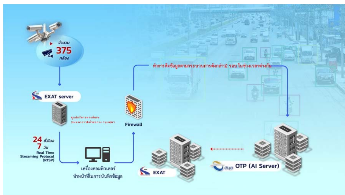
รูปที่ 3.1-17 แนวทางการเชื่อมต่อข้อมูลภาพจากระบบกล้อง CCTV ของการทางพิเศษแห่งประเทศไทย
