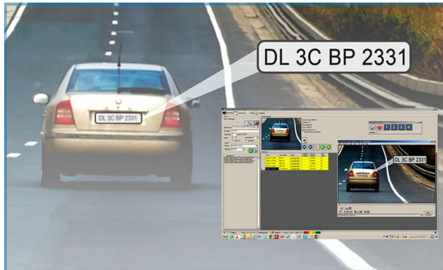
รูปที่ 2.1-10 ตัวอย่างการใช้ AI กับกล้อง CCTV ในการระบุแผ่นป้ายทะเบียนรถ
