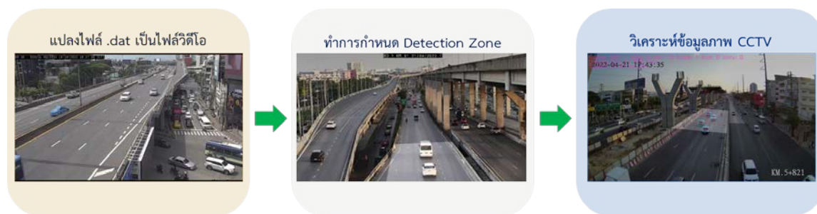
รูปที่ 3.1-8 ขั้นตอนการถอดรหัสและเตรียมข้อมูลภาพวิดีโอ CCTV เพื่อใช้ในการวิเคราะห์ข้อมูลจราจร
