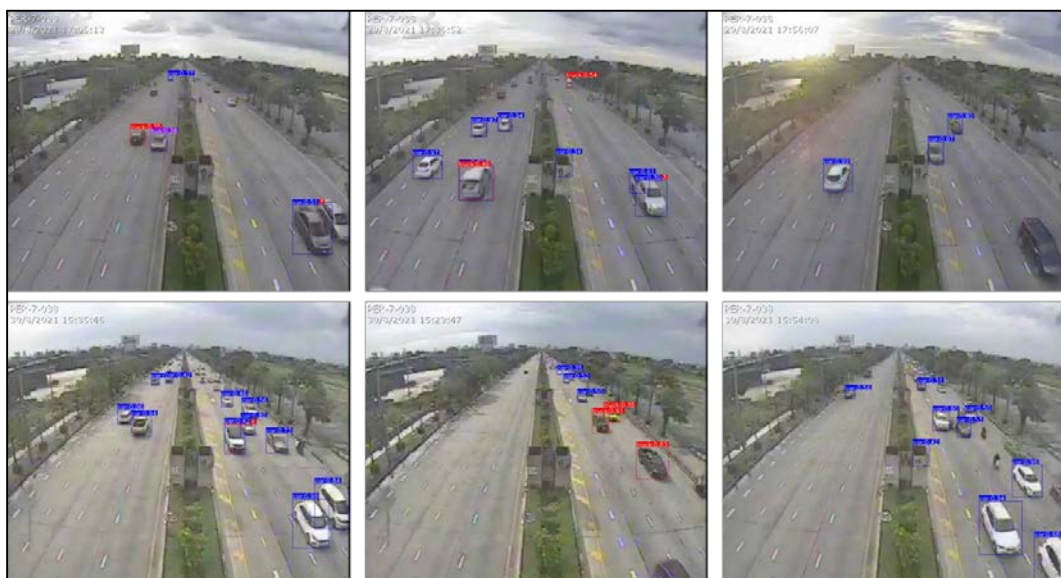
รูปที่ 3.3-22 ตัวอย่างภาพวิดีโอขนาด 60,000 pixels 15 frames/second จากกล้อง CCTV ของกรมทางหลวง
