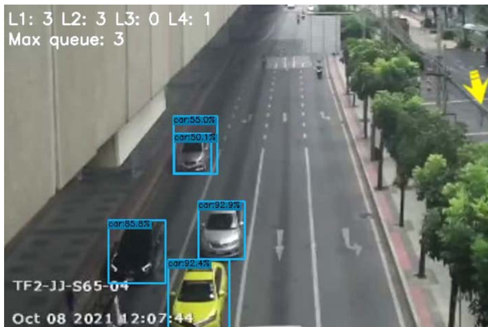
รูปที่ 3.3-29 การวิเคราะห์แถวคอยบริเวณทางแยกโดยใช้ภาพวิดีโอจากกล้อง CCTV ของกรุงเทพมหานคร
