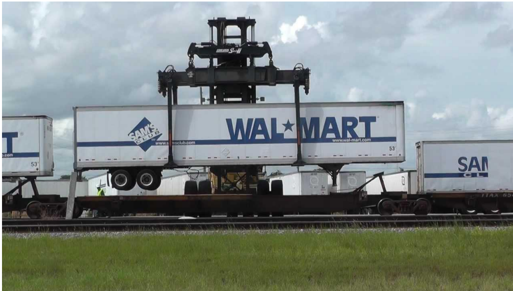
รูปที่ 2.5.7-18 รถเครนที่ใช้ยกสิ่งของ (Mobile Crane) สำหรับรถบรรทุก Semi – Truck
