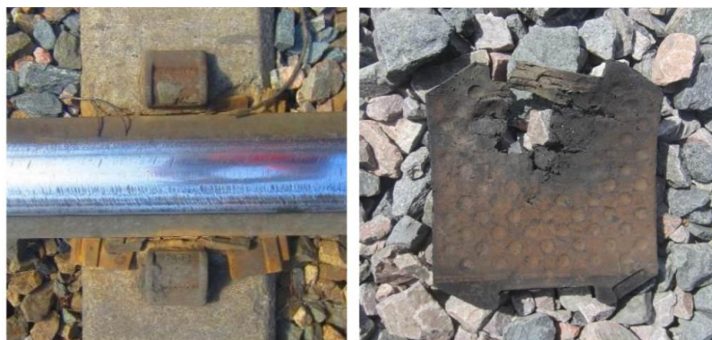
รูปที่ 3-16 การเสียรูปอย่างถาวรและการฉีกขาดของแผ่นรองราง
