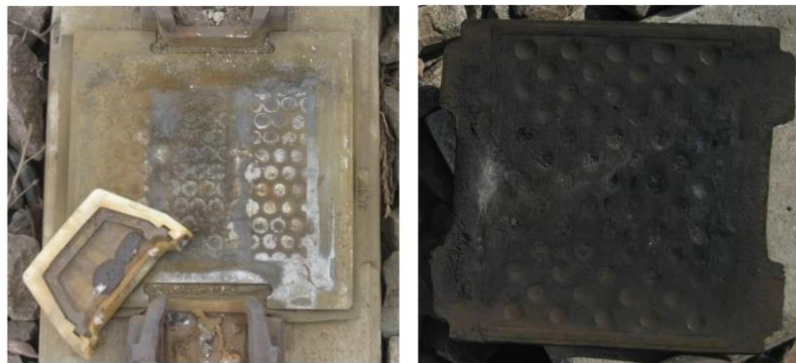
รูปที่ 3-15 การเสื่อมสภาพของแผ่นรองรางเนื่องจากการขัดสี (Abrasion)
