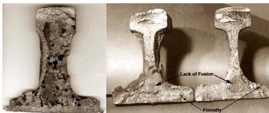
รูปที่ 3-3 โพรงอากาศและการหลอมละลายไม่สมบูรณ์จากการเชื่อมเทอร์มิต (Thermite)
