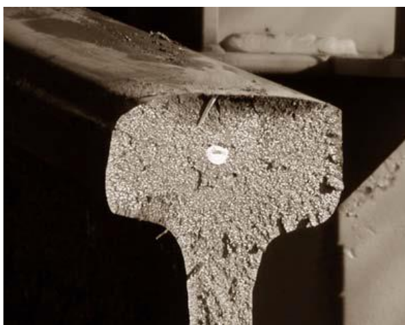
รูปที่ 3-1 ตำหนิ (Defects) ที่อยู่ในเนื้อราง
