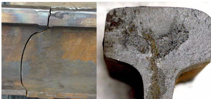
รูปที่ 3-2 การแตกและการหลอมละลายไม่สมบูรณ์จากการเชื่อมไฟฟ้า (Flash Butt)
