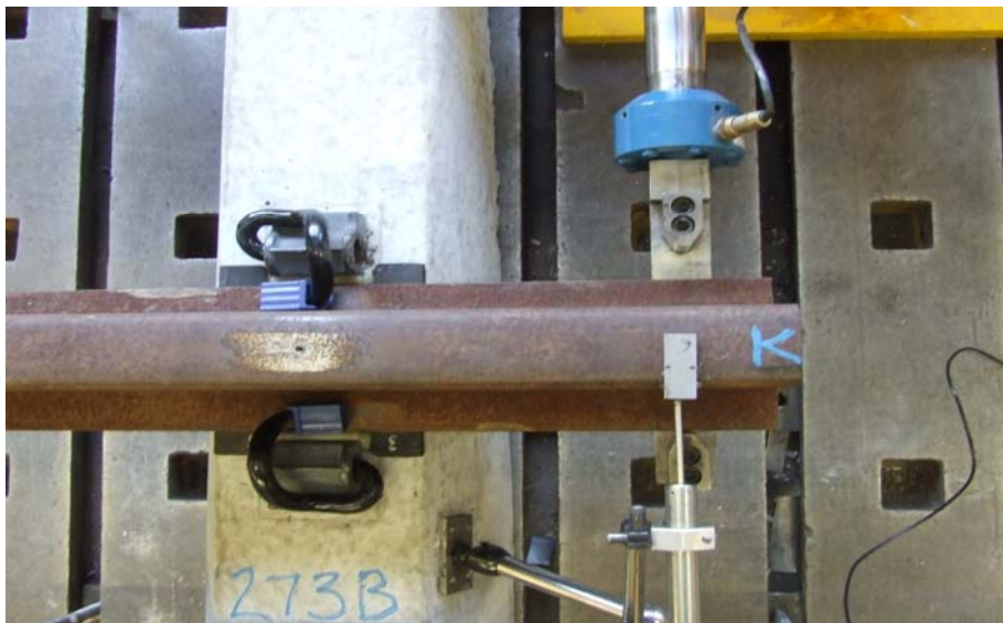
รูปที่ 5-100 ตัวอย่างการทดสอบ torsion test
