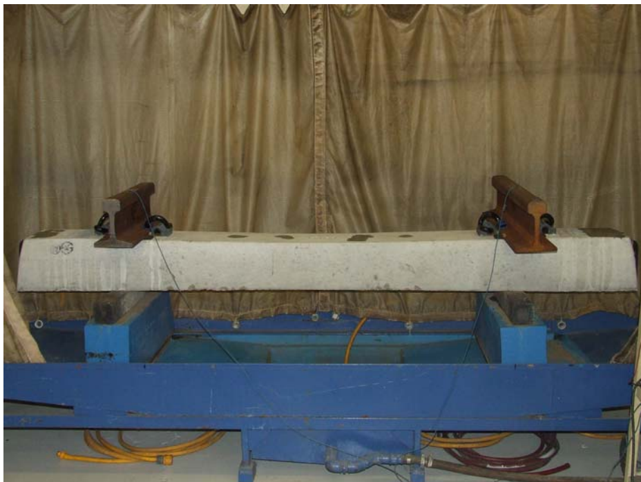
รูปที่ 5-102 ตัวอย่างการทดสอบ Electrical Resistant Test
