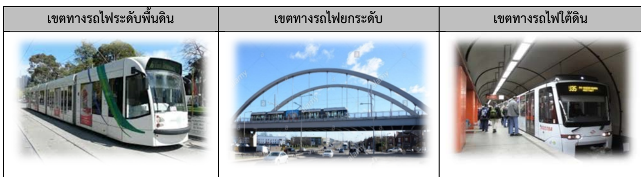
รูปที่ 6-22 แสดงรูปแบบของทางรถไฟของระบบรถไฟฟ้ารางเบา
