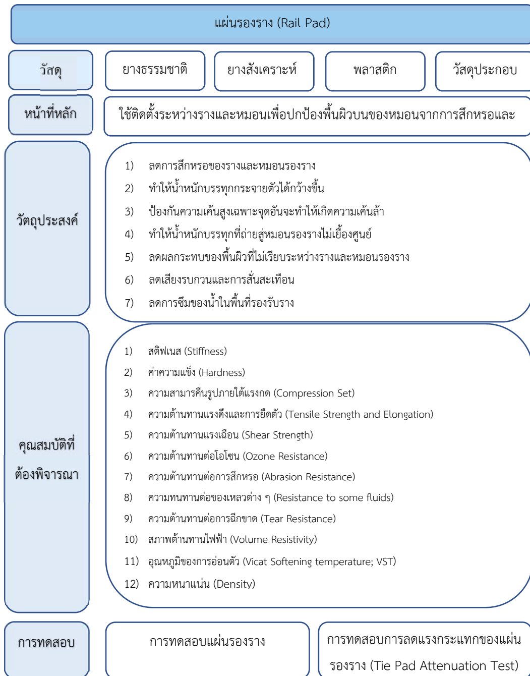
รูปที่ 5-82 ภาพรวมเกี่ยวกับแผ่นรองราง
