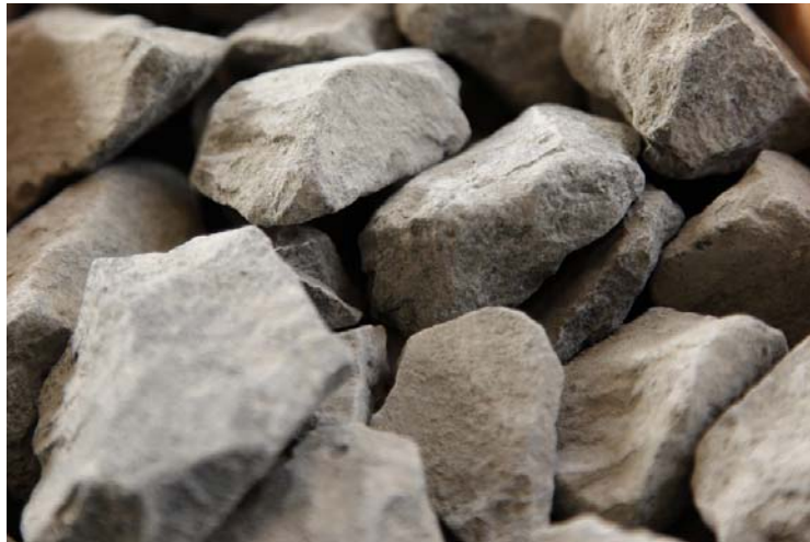
รูปที่ 5-28 ตัวอย่างหินโรยทางที่มีเหลี่ยมมุมและการคละขนาดที่ดี
