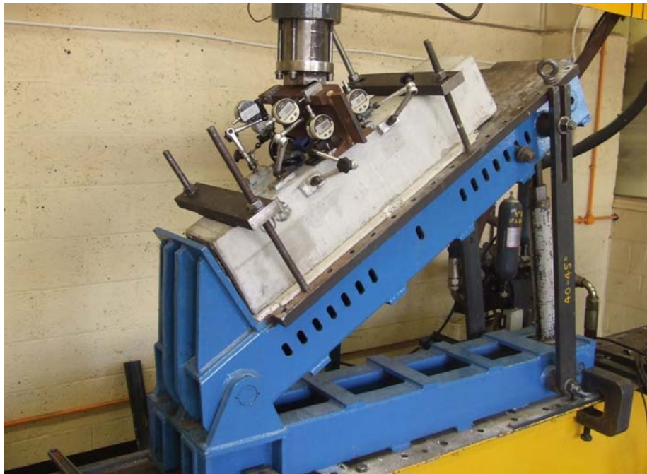
รูปที่ 5-101 ตัวอย่างการทดสอบ Repeat Load Test
