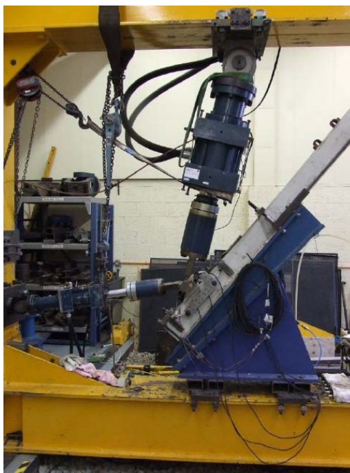
รูปที่ 5-103 ตัวอย่างการทดสอบ repeated load test ของประเทศญี่ปุ่น
