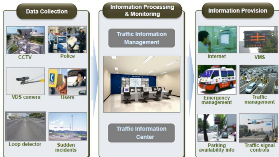
รูปที่ 2.3-14 ระบบ Advance Traffic Management System (ATMS)
