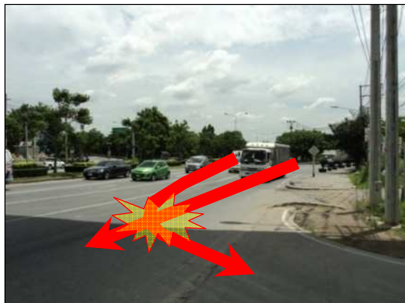
รูปที่ 4.3-4: แสดงสภาพการตัดการจราจรของรถที่เข้าสู่สถานี
