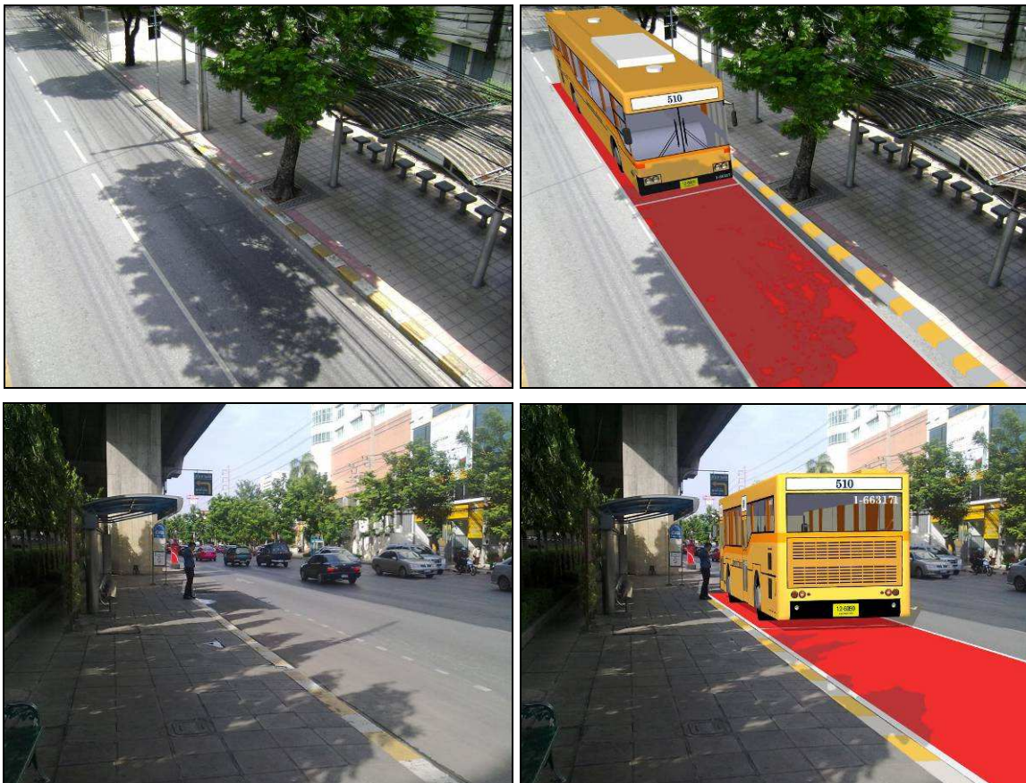
รูปที่ 3.3-26: ทาสีพื้นผิวจราจรบริเวณจุดรับ-ส่ง รถโดยสารประจำทาง
