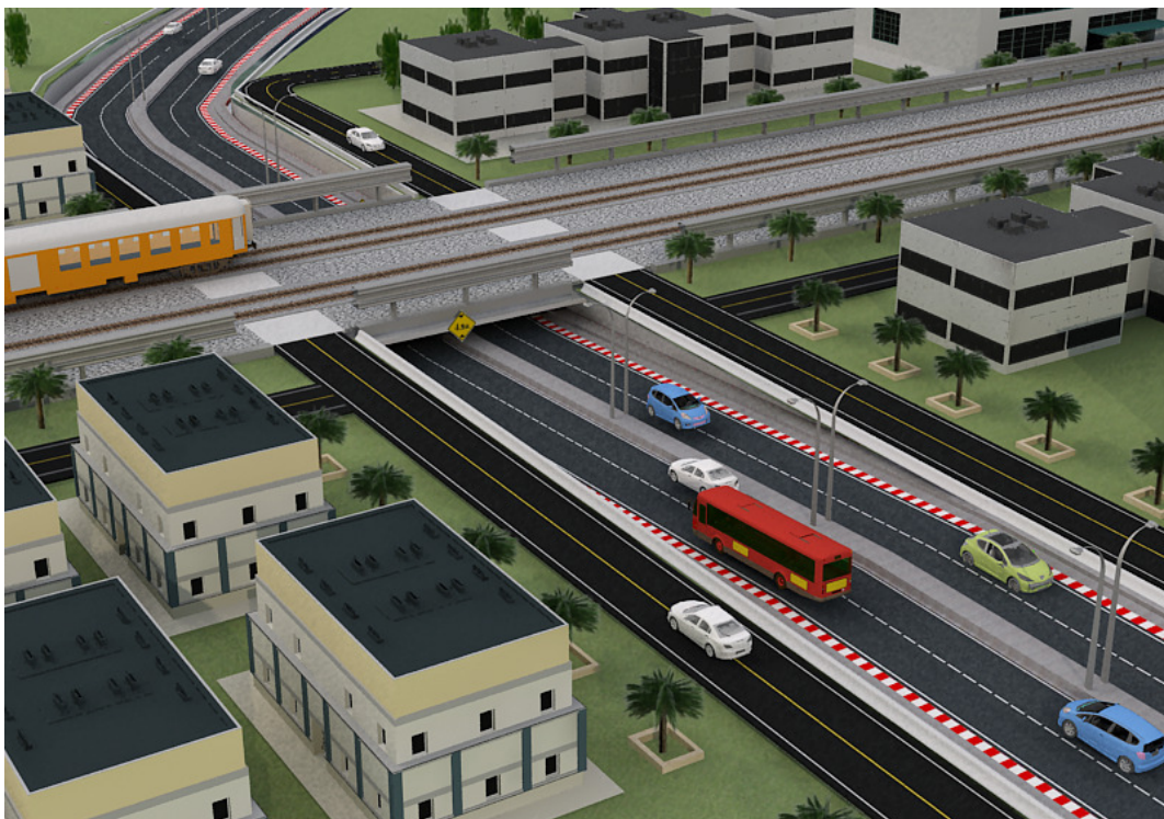
รูปที่ 5.11-2: แสดงแนวคิดรูปแบบในการก่อสร้างทางลอดใต้ทางรถไฟ
