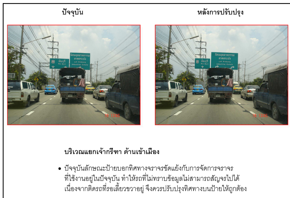
รูปที่ 3.3-6: การปรับปรุงเครื่องหมายและป้ายจราจรบอกทิศทางบริเวณทางแยกเจ้ากรีธา
