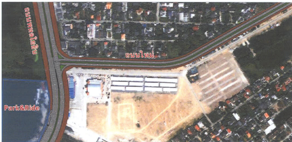
รูปที่ 5.7-4 เชื่อมเป็นสามแยกโดยเปิดเกาะกลางถนน และติดตั้งสัญญาณไฟจราจร
