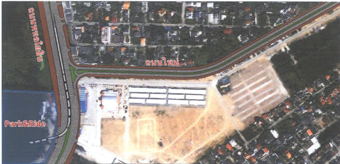
รูปที่ 5.7-5 เป็นสามแยกไม่เปิดเกาะกลางถนนและก่อสร้างสะพานเป็น Directional Ramp
