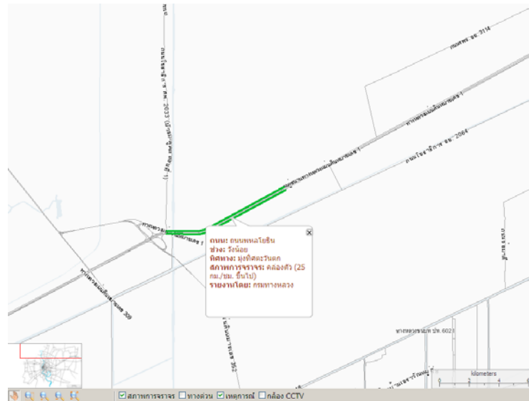
รูปที่ 25 การแสดงผลข้อมูลสภาพการจราจรที่เชื่อมต่อ มาจากอุปกรณ์กล้องอิมเมจโปรเซสเซอร์ในรูปแบบเส้นสีบนแผนที่
