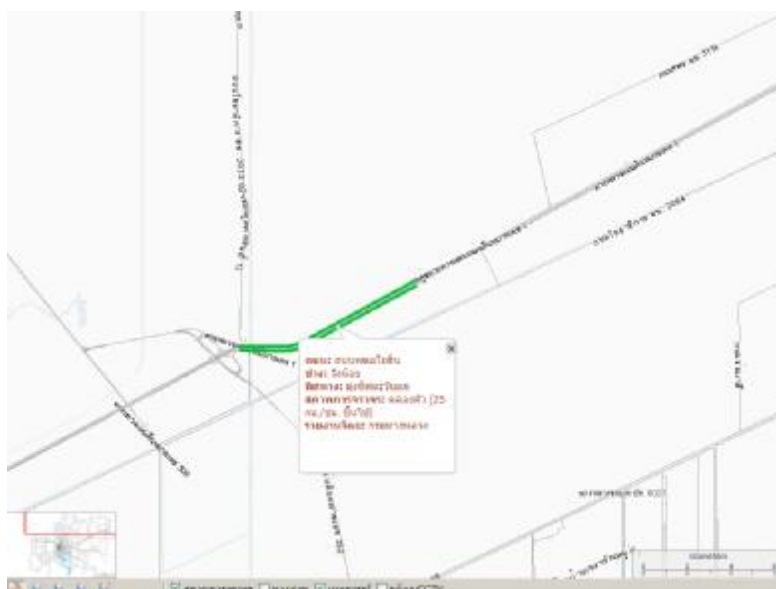
รูปที่ 11.1-1 การแสดงผลข้อมูลสภาพการจราจรที่เชื่อมต่อ มาจากอุปกรณ์กล้องอิมเมจโพรเซสซึ่งในรูปแบบเส้นสีบนแผนที่
