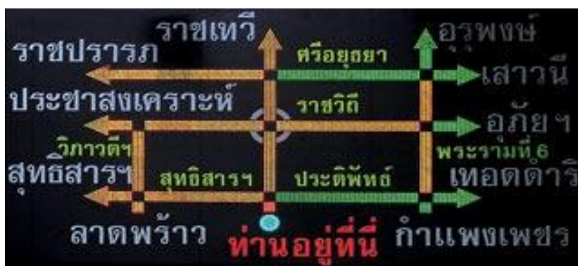
รูปที่ 2.2-4 ป้ายจราจรอัจฉริยะที่ทำการติดตั้งใน กทม.
