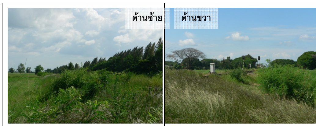
รูปที่ 3.8: แสดงปัญหาสิ่งปลูกสร้าง, พุ่มไม้, หญ้าบริเวณข้างทางรถไฟบดบัง ทำให้ระยะมองเห็นปลอดภัย
