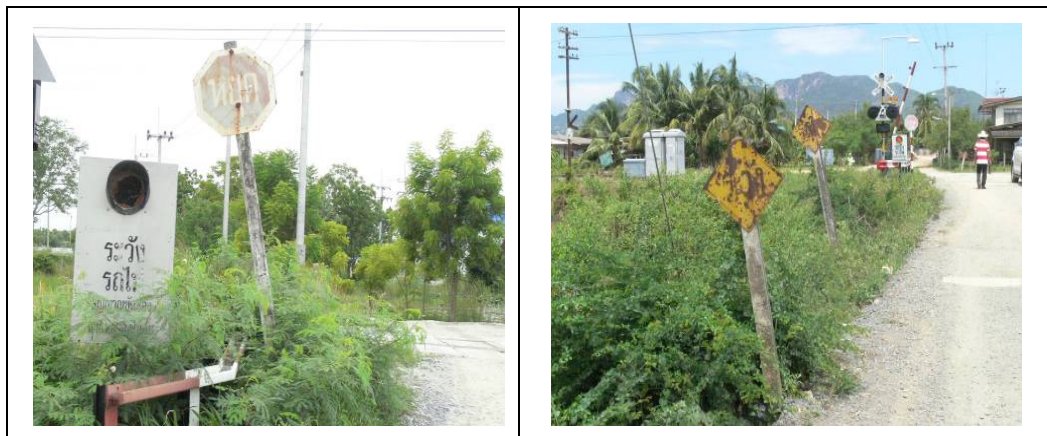
รูปที่ 3.5: แสดงปัญหาเครื่องหมายจราจรไม่ครบถ้วนหรือมีแต่ไม่ได้มาตรฐาน และบางส่วนอยู่ในสภาพชำรุด
