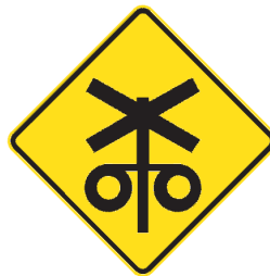
รูปที่ 3.4-9: ป้ายเตือนที่ใช้ควบคุมบริเวณจุดตัดทางรถไฟแบบ Active Crossings
