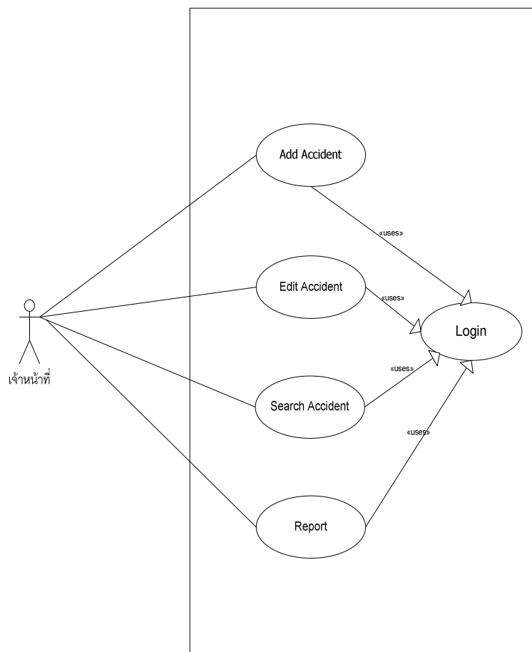
รูปที่ 4.4-4: แผนภาพ Use Case ของระบบการรายงานอุบัติเหตุบริเวณจุดตัดทางรถไฟ
