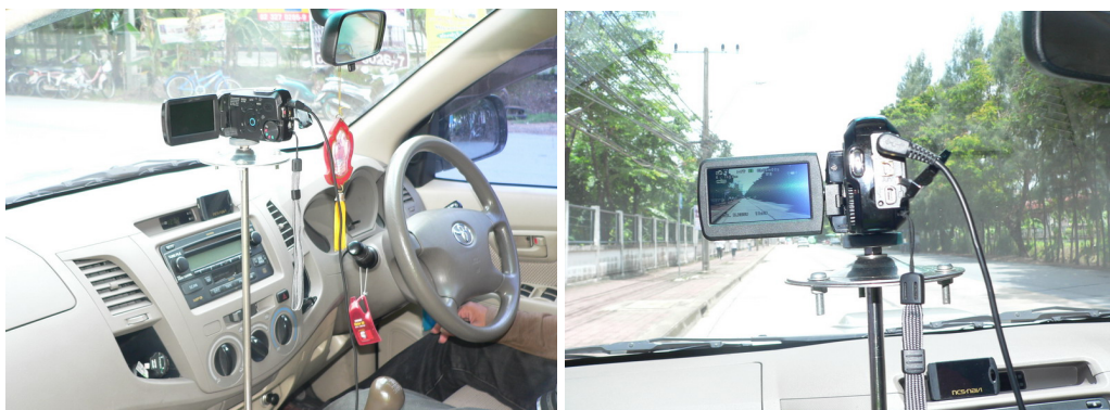
รูปที่ 4.1-3: การติดตั้งกล้องถ่าย VDO ในรถสำรวจ
