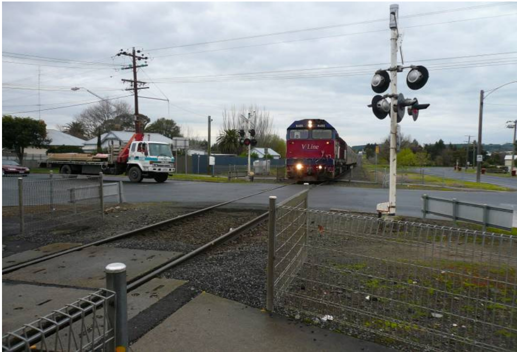
รูปที่ 3.4-13: การเปิดไฟใหญ่หน้ารถจักร (ด้านบน) และไฟเล็ก (ด้านล่าง) ขณะทำขบวนเข้าสู่จุดตัดแบบมีสัญญาณเตือน
