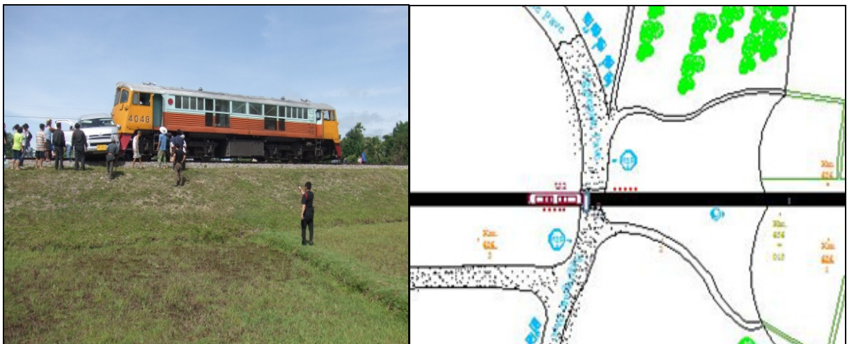
รูปที่ 2.4-3: แสดงหัวรถไฟชนและดันให้รถตู้ไถลไปข้ามทางรถไฟตามรางและหยุดห่างจากจุดชน 150 เมตร และฝั่งบริเวณทางตัดทางรถไฟ รถตู้เริ่มออกตัว ขณะนั้นหัวรถไฟเที่ยวล่องกำลังวิ่งเข้ามา
