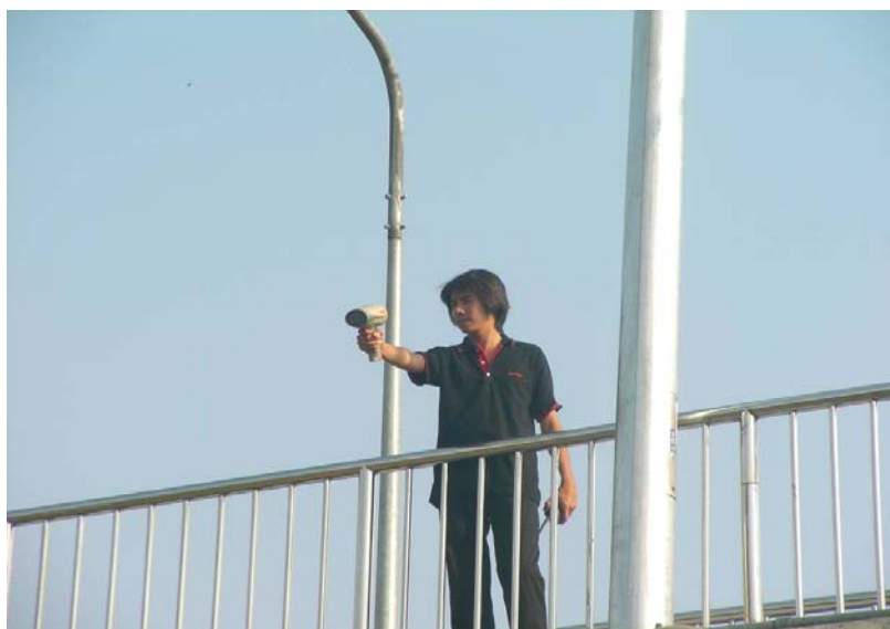
รูปที่ 7.2-1 การวัดความเร็วโดยใช้ Speed Gun
