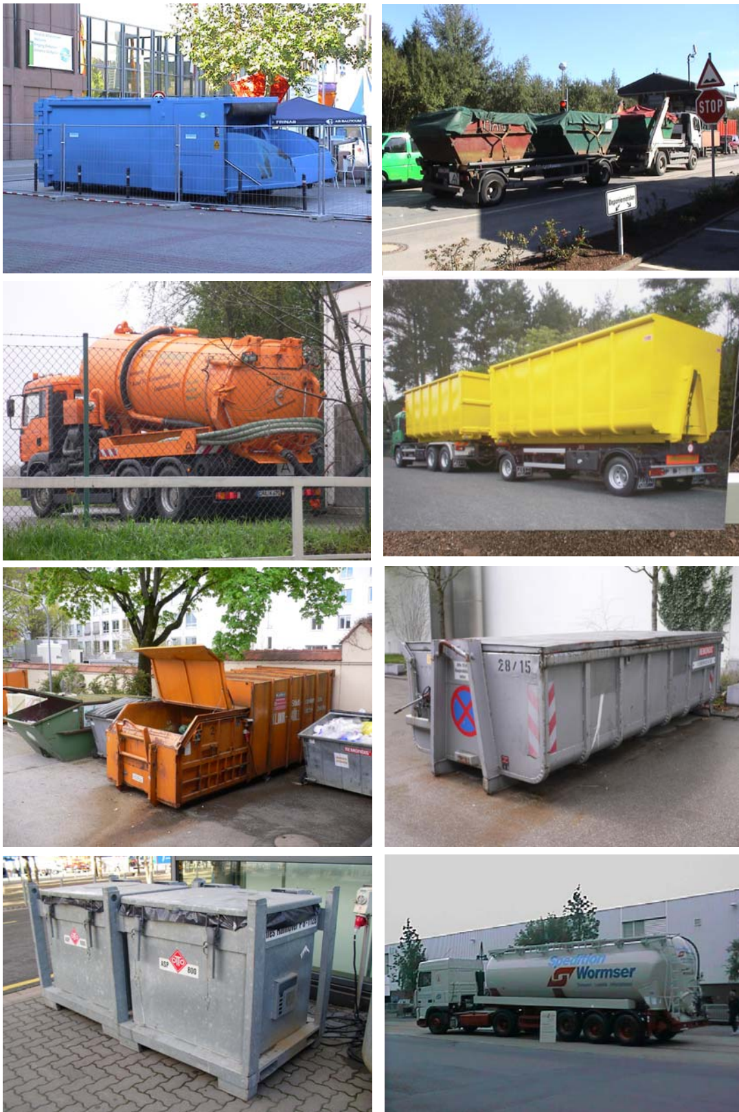
รูปที่ 4.1-3: แท็งก์ที่ใช้ภาชนะที่บรรจุของเสียฯ ที่เป็นของแข็งหรือตะกอน
