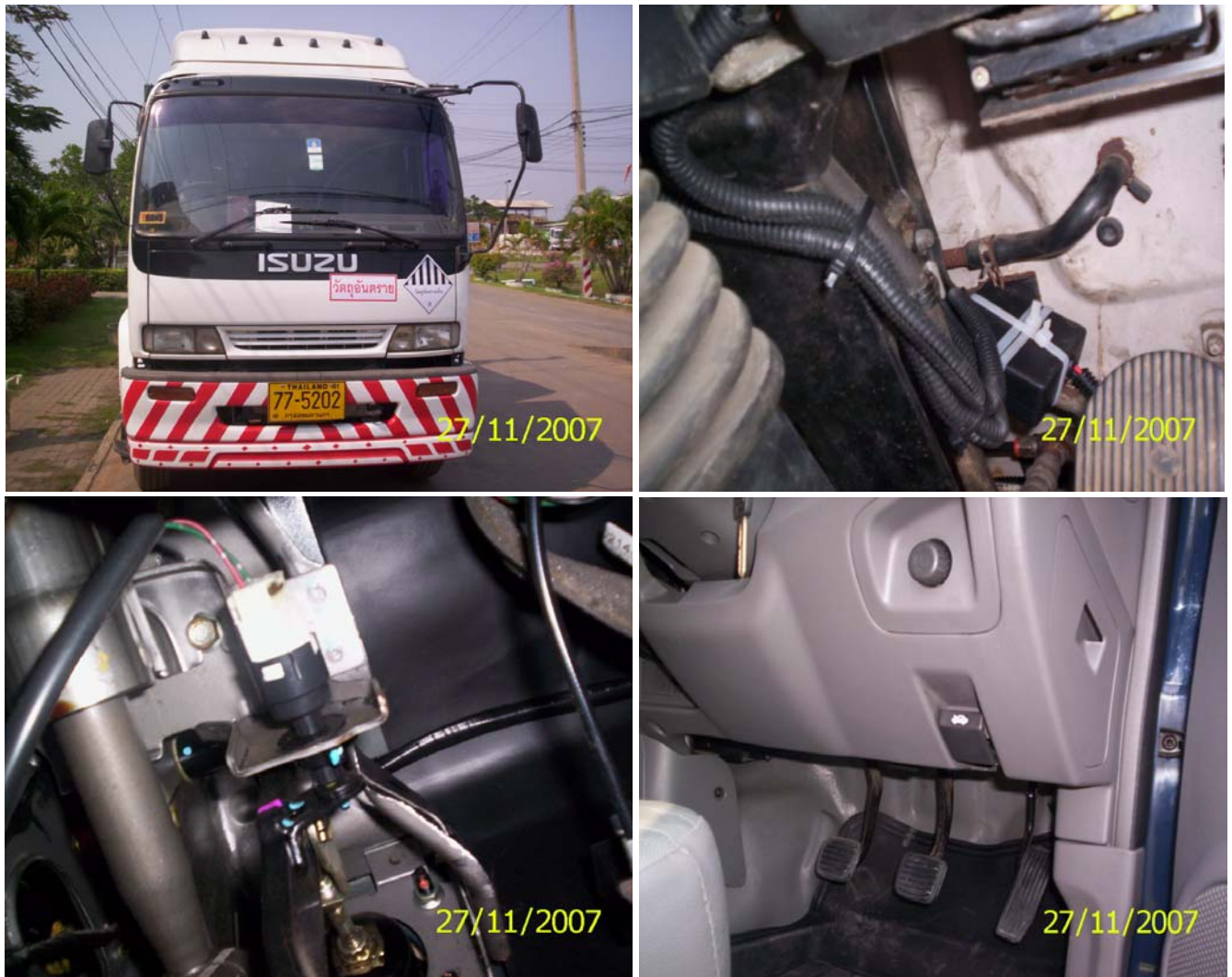
รูปที่ 3.2-6: การติดตั้งอุปกรณ์ติดตามที่รถขนส่งของเสียและกากอุตสาหกรรม
