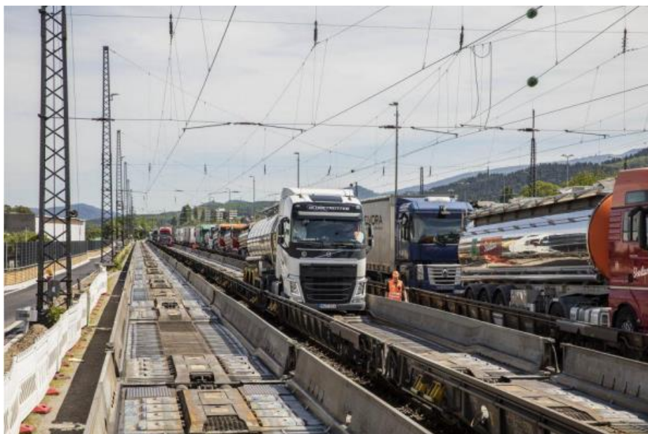
รูปที่ 2.5.7-17 สะพานโหลดสินค้า (Loading Ramp) สำหรับรถบรรทุกที่ขนเต็มคันโดยไม่ผ่านคลังสินค้า (Full Truck)
