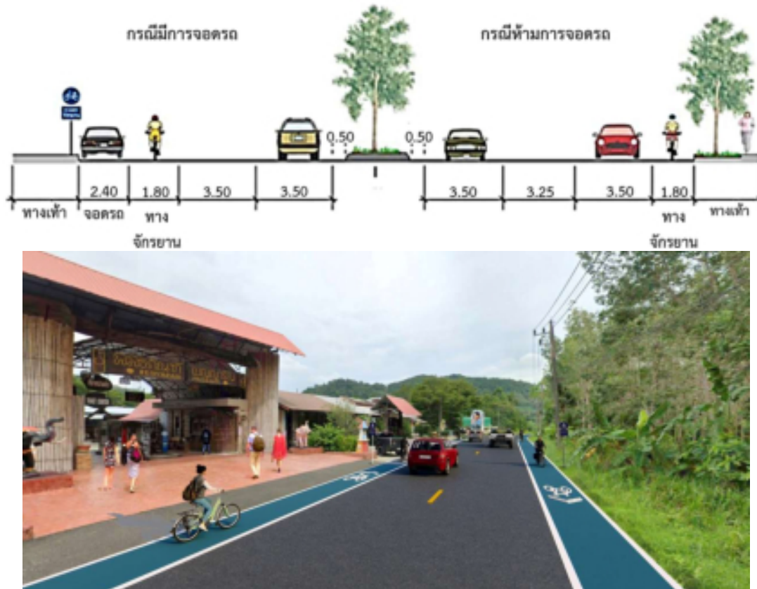
รูปที่ 5.1 - 42 ทางจักรยานแบบแบ่งพื้นที่สำหรับจักรยาน (Bicycle Lane)
