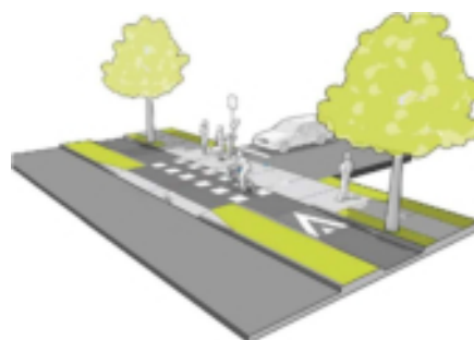
รูปที่ 5.1 - 46 ระยะลาดชันของการยกพื้นทางเดินข้ามและทางจักรยานใช้ร่วมกัน
