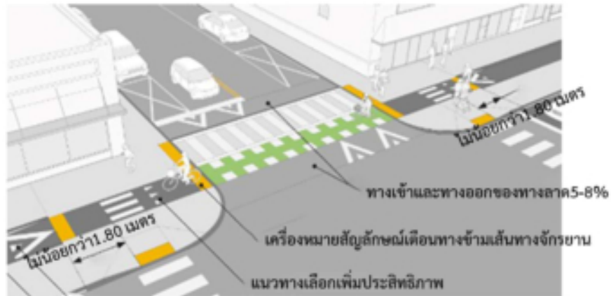
รูปที่ 5.1 - 45 ทางข้ามจุดตัดแบบทางจักรยานใช้ร่วมกับทางเดินเท้า (Share Use Path Crossings)
