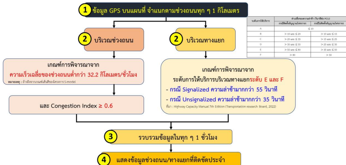
รูปที่ 5.1.1-7 การวิเคราะห์พื้นที่ที่มีการจราจรติดขัดเป็นประจำ
