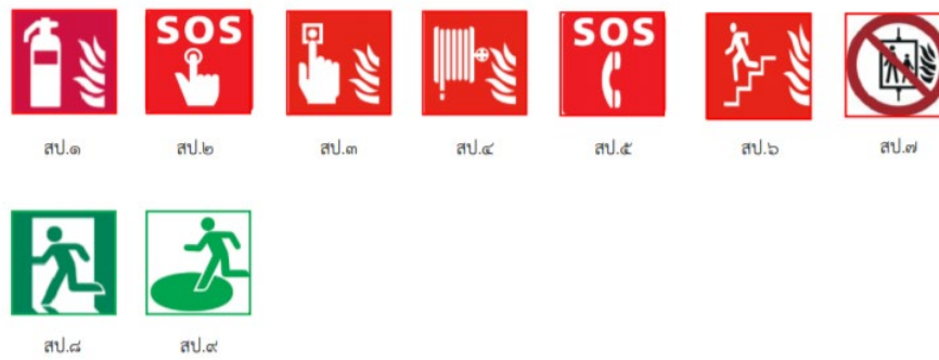
รูปที่ 2.1. 32-5 ป้ายสัญลักษณ์ความปลอดภัย (Safety)
