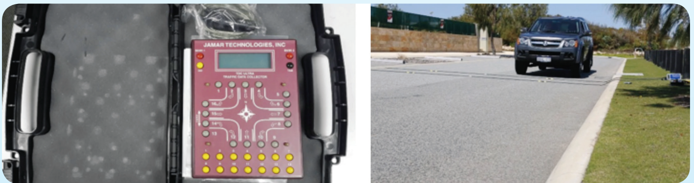
รูปที่ 3 อุปกรณ์ที่ใช้ในการนับปริมาณจราจร
