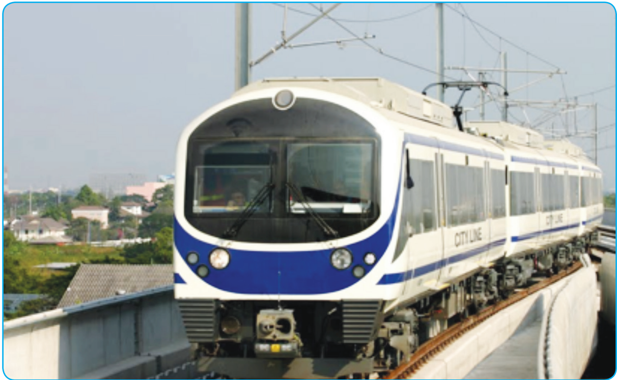
รูปที่ 2 รถไฟฟ้าแอร์พอร์ตเรลลิงก์ที่รับไฟฟ้าจากระบบจ่ายไฟฟ้าเหนือพื้นดิน
