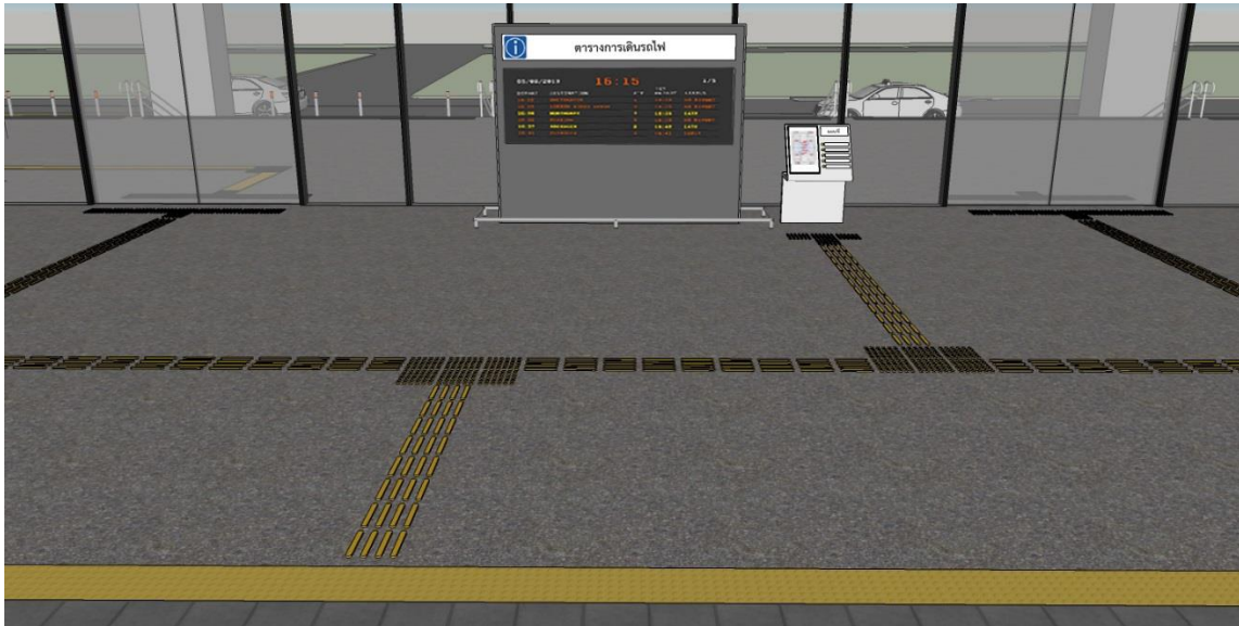
ภาพที่ 238 พื้นชานชาลาสำหรับรถไฟธรรมดา มีการติดตั้งผิวต่างสัมผัสเตือนและนำทาง และป้ายแสดงตารางการเดินรถไฟ แผนสำหรับคนทุกคน ระหว่างชานชาลากับรางรถไฟ ชั้นที่ 1
