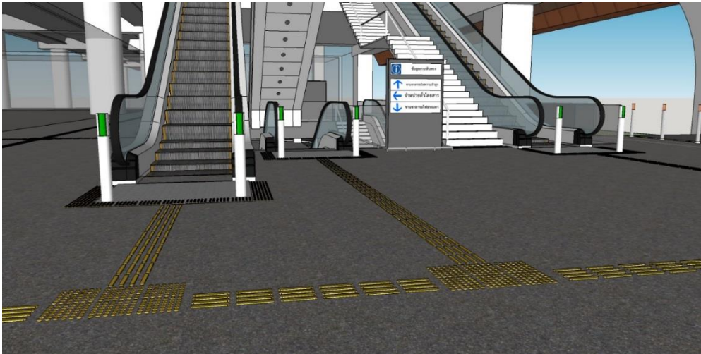
ภาพที่ 250 ชั้น Concourse บันไดเลื่อน และป้ายบอกทาง ขึ้น-ลง ตู้ชานชาลา มีการติดตั้งผิวต่างสัมผัสนำทางไปยังบันไดเลื่อน และเตือนก่อนถึงบันไดเลื่อน พร้อมติดตั้งเสาเซ็นเซอร์เพื่อส่งเสียงเตือนผู้ที่เข้าผิดทิศทาง
