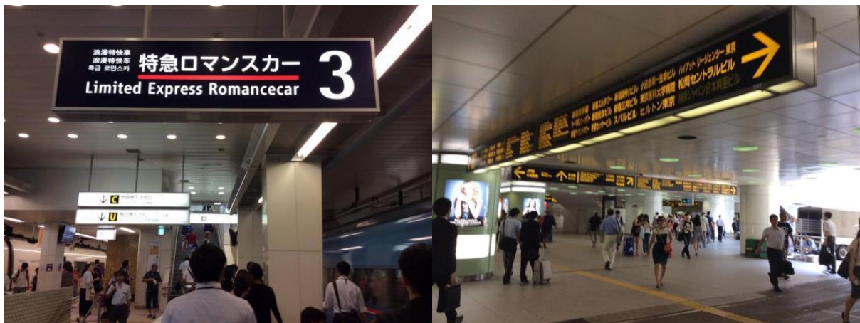
ภาพที่ 49 ตัวอย่างป้ายที่ใช้ภายในอาคาร มีแสงสว่างส่องจากภายใน ช่วยให้เห็นชัดเจนทั้งกลางวันและกลางคืน มักใช้ตัวอักษรภาษาอังกฤษแบบเรียบ ไม่มีเชิง (Sans Serif) และพื้นทีหลังสีเข้ม เพื่อให้ตัดกันชัดเจน
