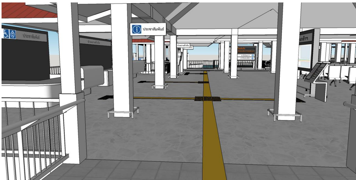
ภาพที่ 303 ทางเดินสู่เคาน์เตอร์ประชาสัมพันธ์และขยายตัวภายในอาคารผู้โดยสาร มีการติดตั้งผิวต่างสัมผัสเตือนและนำทาง และราวกันชนรอบเสา*
