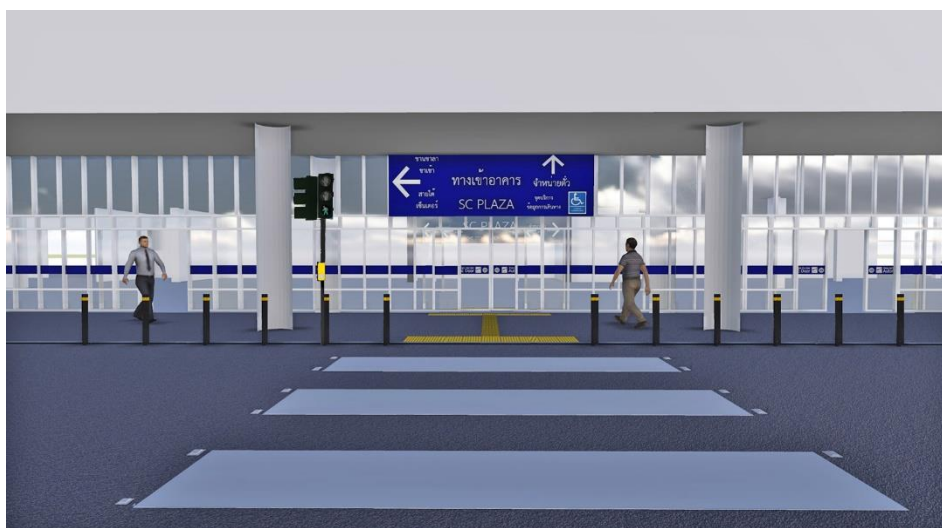
ภาพที่ 88 ทางข้ามจากจุดจอดรถแท็กซี่เข้าสู่อาคารสถานีได้ยกระดับพื้นของทางม้าลายบริเวณทางข้ามสถานี มีการยกระดับพื้นของทางม้าลายบริเวณทางข้ามเพื่อชะลอความเร็ว และทำให้เกิดความต่อเนื่องทางราบระหว่างทางเท้าและผิวถนนเพื่ออำนวยความสะดวกการใช้งานของคนพิการและผู้สูงอายุที่เสนอให้ปรับปรุง
