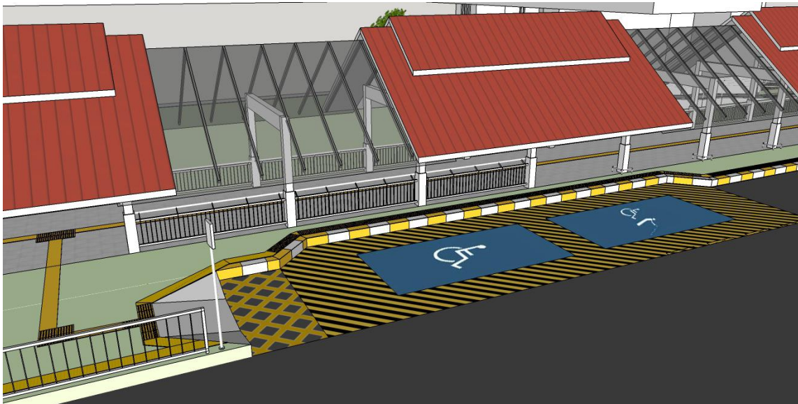
ภาพที่ 291 พื้นที่จอดรถรับส่ง (Drop-off Area) ของคนพิการ ที่เชื่อมต่อสู่ทางเดินหลังคาคลุม*
