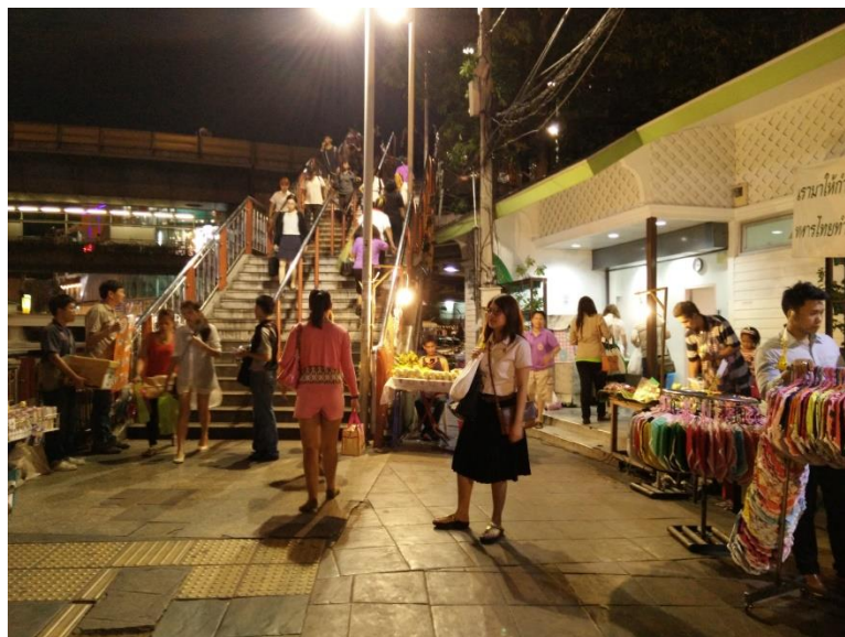
ภาพที่ 148 พื้นผิวทางเดินและพื้นผิวต่างสัมผัสที่ไม่สามารถใช้งานได้อย่างมีประสิทธิภาพ
