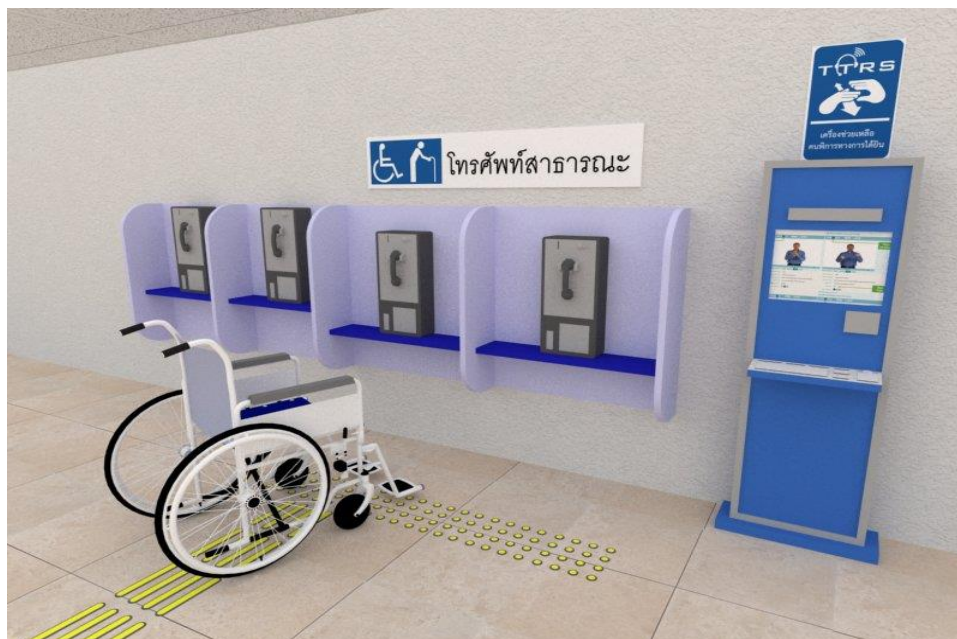
ภาพที่ 198 โทรศัพท์สาธารณะและเครื่อง TTRS สำหรับคนพิการทางการได้ยินหรือสื่อความหมาย
