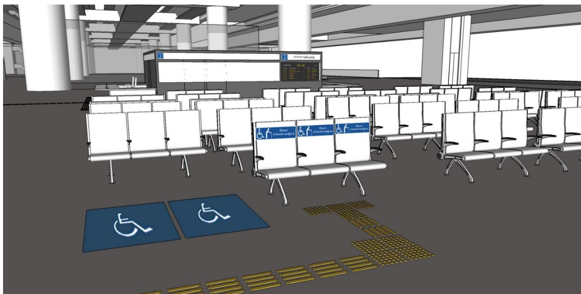
ภาพที่ 244 ชั้น Concourse ที่นั่งสำหรับคนพิการและผู้สูงอายุและพื้นที่สำหรับจอดรถเข็นคนพิการ มีป้ายบอกตำแหน่งและทาสีพื้นบริเวณที่จอดรถเข็นคนพิการ
