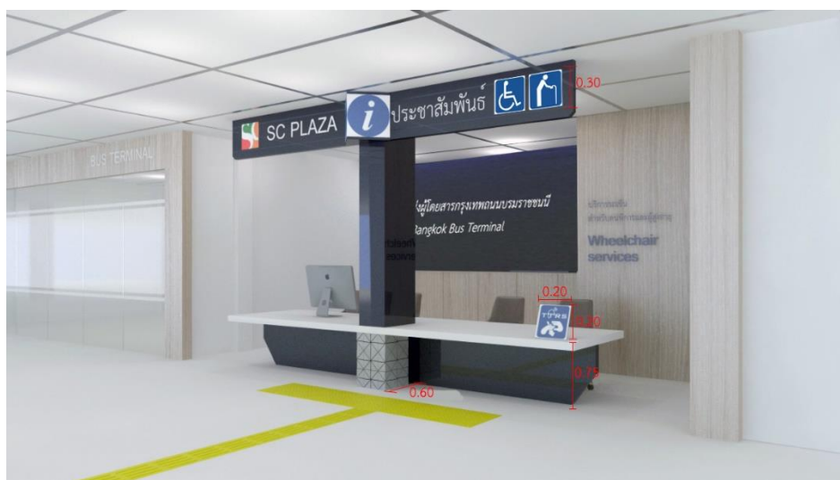
ภาพที่ 94 ลักษณะรูปแบบเคาน์เตอร์ ที่มีความสูงที่เหมาะสมกับการใช้งาน มีการติดตั้งสัญลักษณ์คนพิการและผู้สูงอายุ บนโต๊ะมีป้ายสัญลักษณ์เพื่อให้คนพิการทางการได้ยินทราบว่าสามารถขอความช่วยเหลือได้จุดนี้
