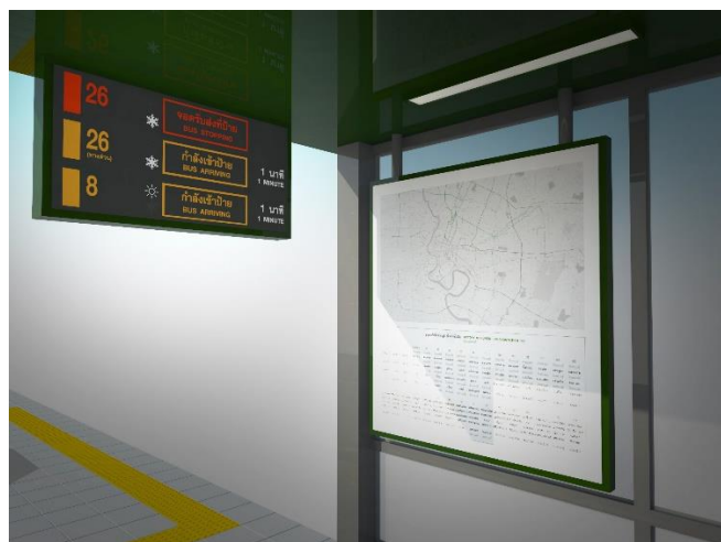
ภาพที่ 135 ป้ายเตือนและป้ายข้อมูลเส้นทางการเดินทางที่เสนอให้ปรับปรุงติดตั้งป้ายบอกข้อมูลการเดินทางแบบ Real-time แจ้งสายรถที่กำลังจะเข้าจอด โดยให้ข้อมูลเป็นตัวอักษรสีส้ม ซึ่งคนตาบอดสีสามารถแยกแยะได้
