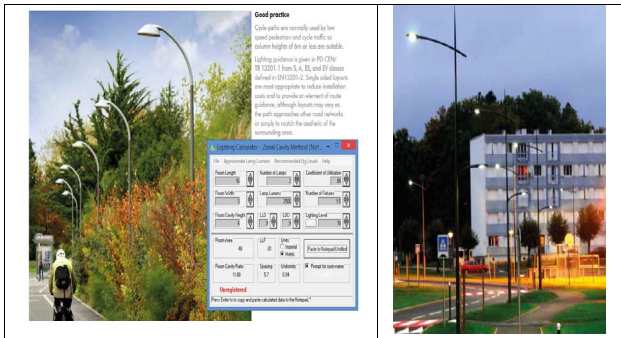
รูปที่ 3.20 แสดงการคำนวณการติดตั้งระบบไฟฟ้าแสงสว่างบนทางจักรยาน ที่มา : Thorn Lighting (2014)
