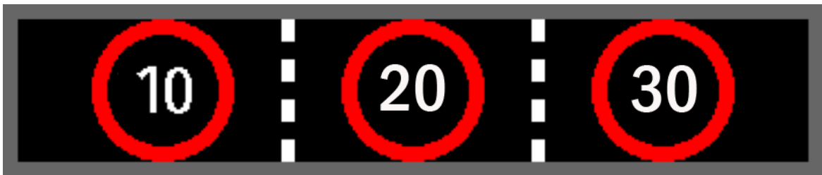
รูปที่ 3.19 แสดง สัญลักษณ์จราจร บังคับความเร็ว แสดงบนป้าย VMS ขนาดตามมาตรฐาน EU
