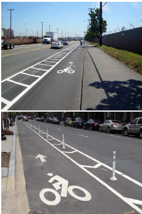
รูปที่ 2.22 ทางจักรยานแบบจัดทำพื้นที่กันชน (Buffer)
