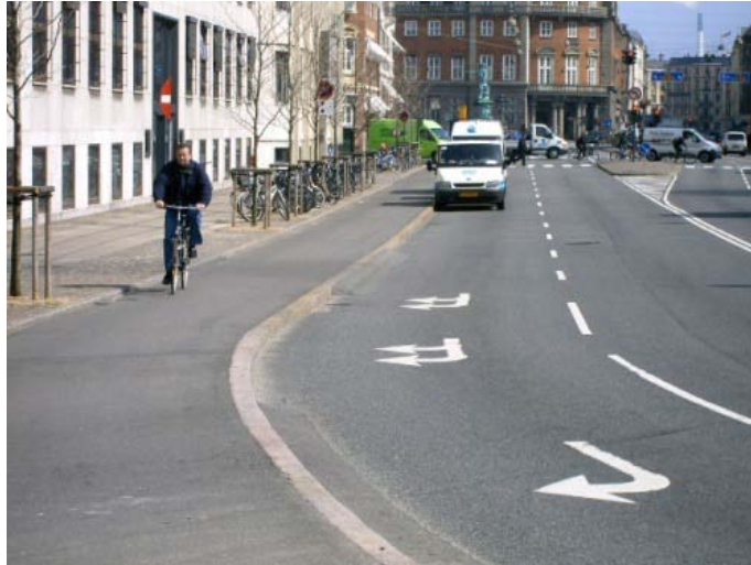
รูปที่ 2.6 การใช้ขอบคันหินจัดพื้นที่เฉพาะสำหรับจักรยาน (Over the Bars in Wisconsin, 2010)
