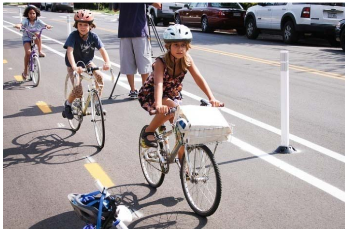
รูปที่ 2.7 การใช้เสาจัดพื้นที่เฉพาะสำหรับจักรยาน (City of Austin)
