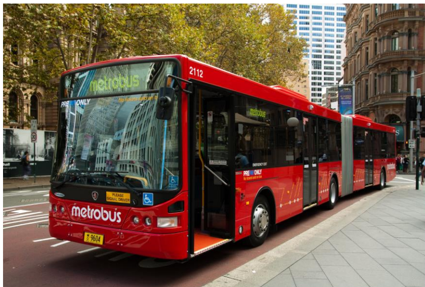
รูปที่ 17 รถโดยสารประจำทางพ่วง (Articulated chassis) รุ่นพื้นต่ำ (Low-floor) ของหน่วยงาน Sydney Metrobus
