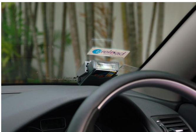
เครื่องติดตั้งในรถสำหรับค่าใช้ถนนอิเล็กทรอนิกส์
