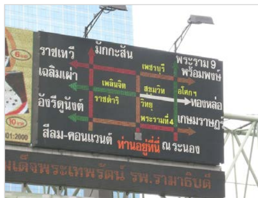
รูปที่ 4.2-6 ป้ายแสดงความติดขัดของการจราจร
