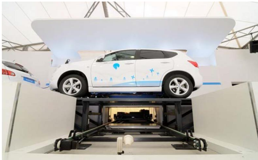
รูปที่ 17 ตัวอย่างสถานีสับเปลี่ยนแบตเตอรี่สำหรับยานยนต์ไฟฟ้า 16
