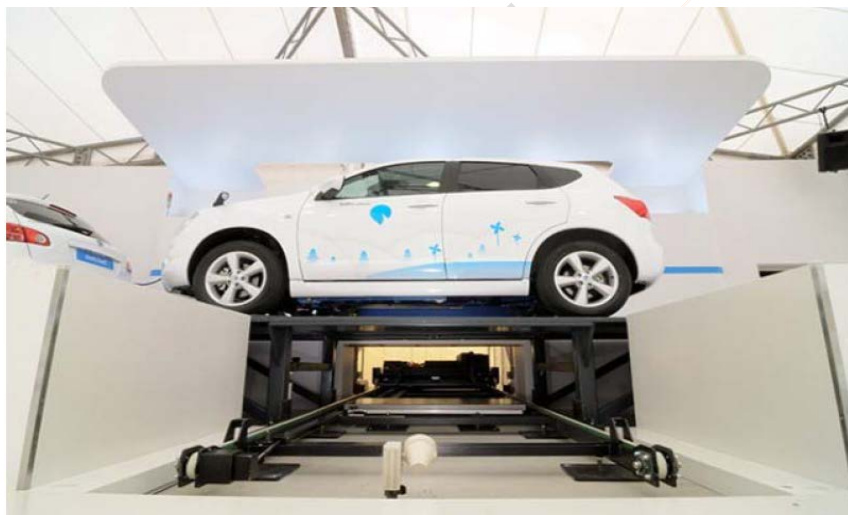
รูปที่ 17 ตัวอย่างสถานีสับเปลี่ยนแบบเตอรีสำหรับยานยนต์ไฟฟ้า 16
