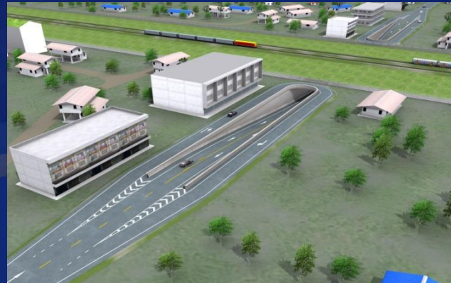
ทางรถยนต์ลอดทางรถไฟ (Underpass)
