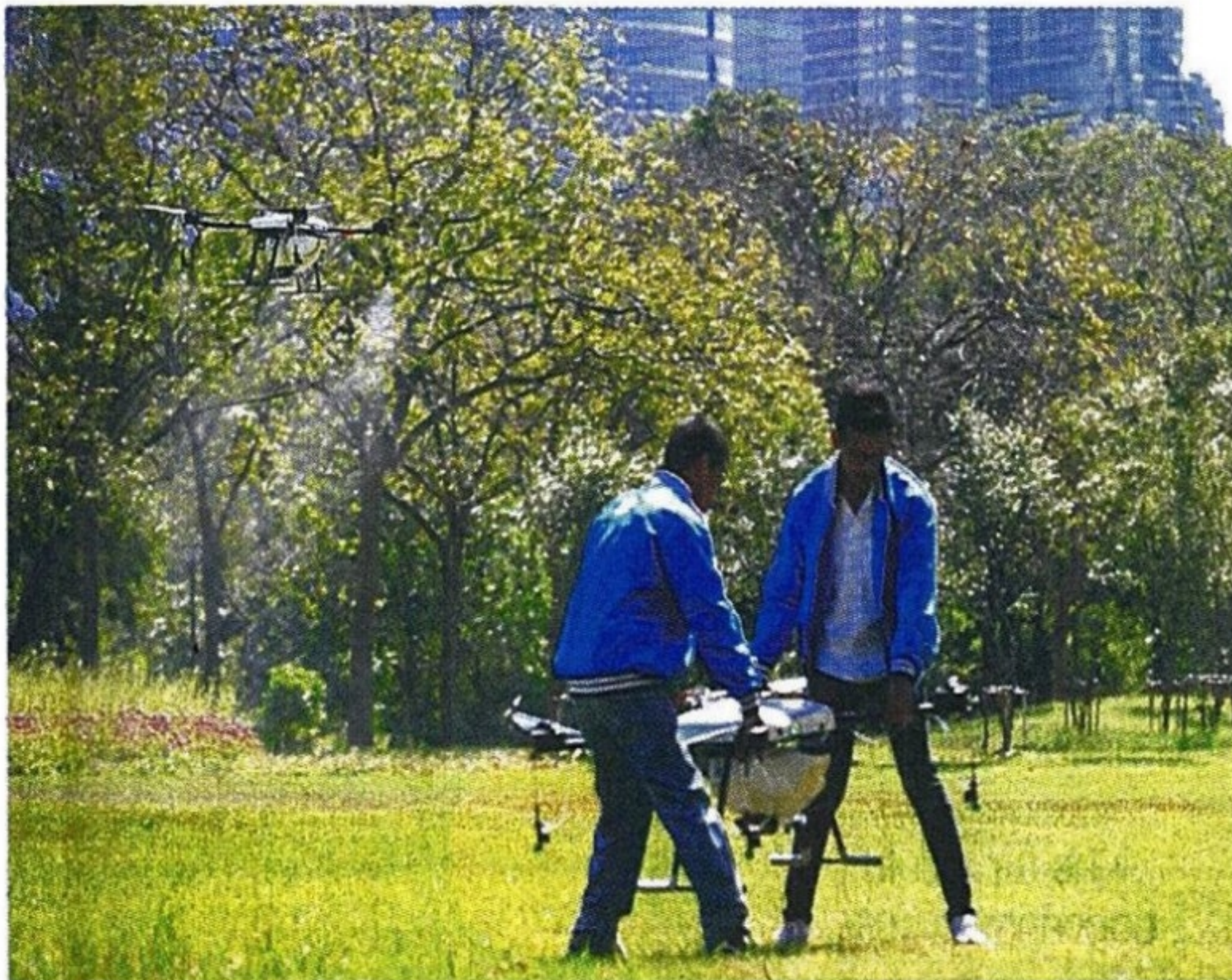
ทดลองบิน : สถาบันเทคโนโลยีป้องกันประเทศ (สทป.) ร่วมกับสำนักงานพัฒนาวิทยาศาสตร์และเทคโนโลยีแห่งชาติ(สวทช.) และกรมควบคุมมลพิษ นำอากาศยานไร้คนขับทดสอบฉีดพ่นละอองน้ำผสมสารดักจับฝุ่นละอองขนาดเล็ก ที่สวนวชิรเบญจทัศ
